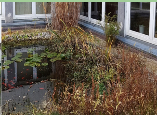
Oczko wodne przy szkole zasilane wodami opadowymi z dachu
